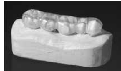
Abb. 1 – Zweite Versuchsanordnung zur experimentellen Prüfung der Streustrahlung bei verschiedenen Dentalwerkstoffen. Die Zähne A bis E sind von rechts nach links angeordnet. Um die Zähne noch differenzieren zu können, wurde nur für diese Abbildung eine dünnere Tiefziehfolie verwendet.
