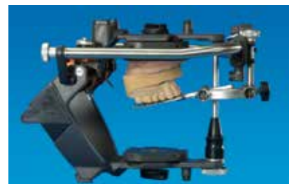
Abb. 25: Arbiträrer Gesichtsbogen mit einartikuliertem Oberkiefermodell
