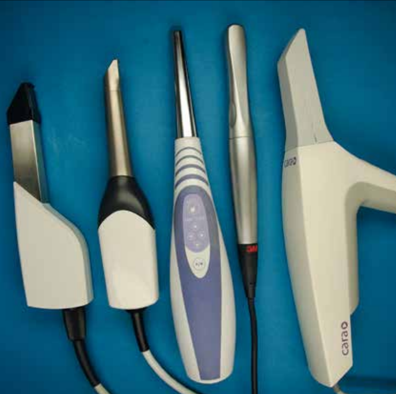
Abb. 1: Kamerasysteme, von links nach rechts: CEREC Bluecam; CEREC Omnicam; LAVA C.O.S.; True Definition Scanner, Cara Trios True Color System
