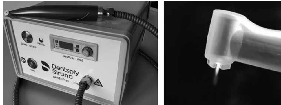
Abbildung 2: Fotografie des Plasmageräts (links) und des Plasmakopfs mit der sichtbaren kalten Flamme (rechts), mit der in rauen Implantatstrukturen verbliebene Mikroorganismen inaktiviert werden und die Titanoberfläche hydrophilisiert wird.
