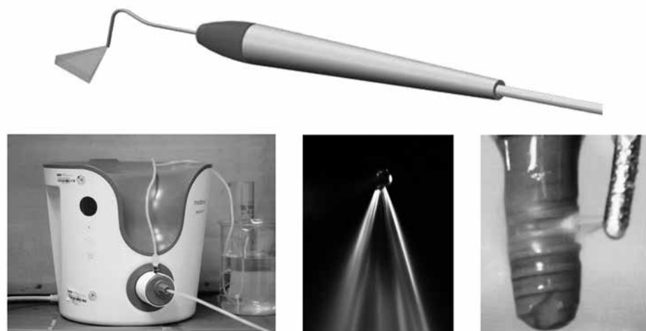
Abbildung 1: Schematische Abbildung des Handstücks mit der speziell für den intraoralen Einsatz geformten Spitze (oben) und Fotografien des Wasserstrahlgeräts (links) und des Wasserstrahls aus der für die dentale Anwendung entwickelten Düse, mit der der Biofilm von der Implantatoberfläche entfernt wird (mitte, rechts). Foto: Verfasser (4)
