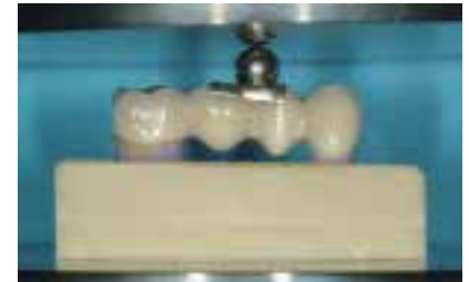
Abb. 4: Aufbau der Bruchlastprüfung.
